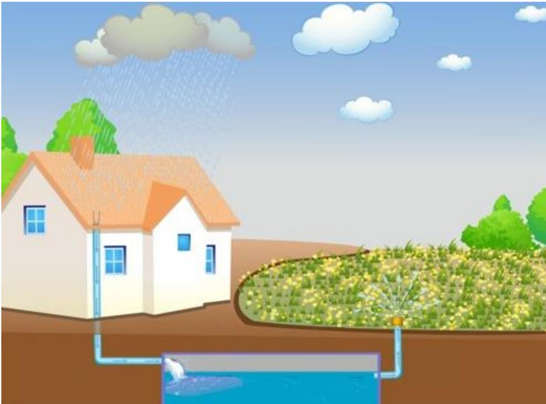
La récupération des eaux de pluie est le processus de collecte et de stockage de l'eau de pluie plutôt que de la laisser s'écouler. L'importance de la collecte de l'eau de pluie est qu'elle peut être stockée pour une utilisation future car l'eau de pluie est pure et fraîche ; il peut être utilisé directement à de nombreuses fins domestiques telles que le nettoyage, la lessive et le jardinage.
