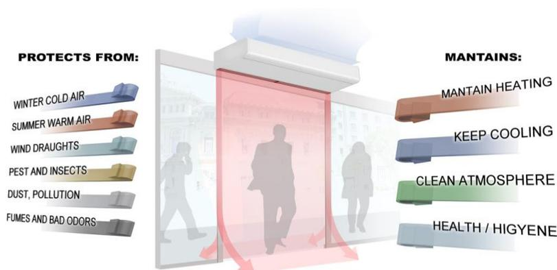
Pour être plus efficace, le rideau d'air doit être monté à l'intérieur du foyer/vestibule, au-dessus de la porte d'entrée du bâtiment. Selon les conditions climatiques, un modèle chauffé ou non chauffé peut être utilisé.
